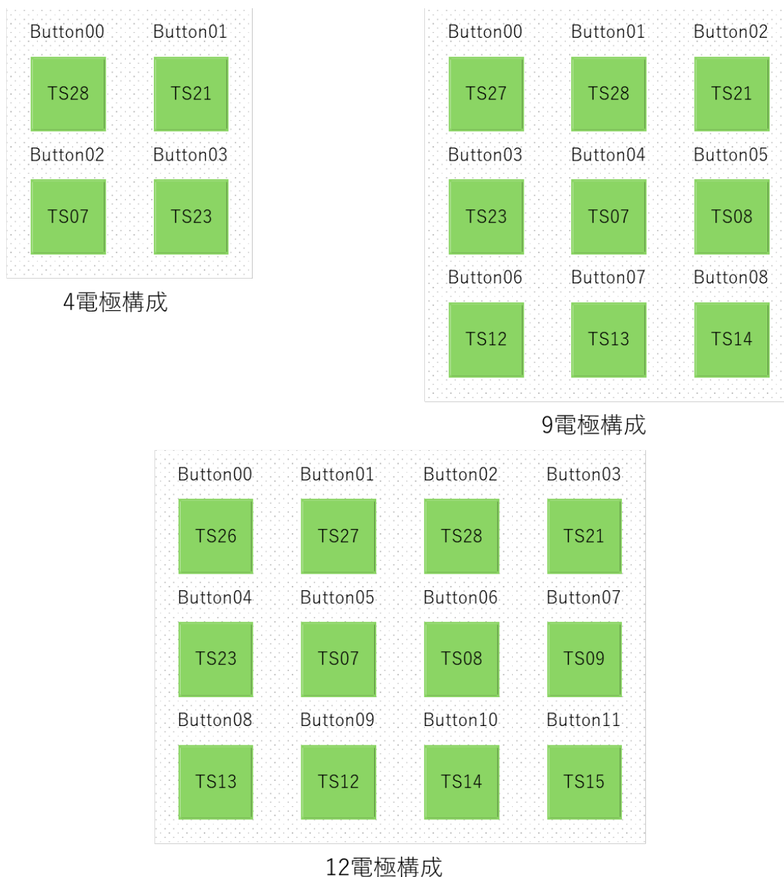
図 5.2 タッチインタフェース構成
