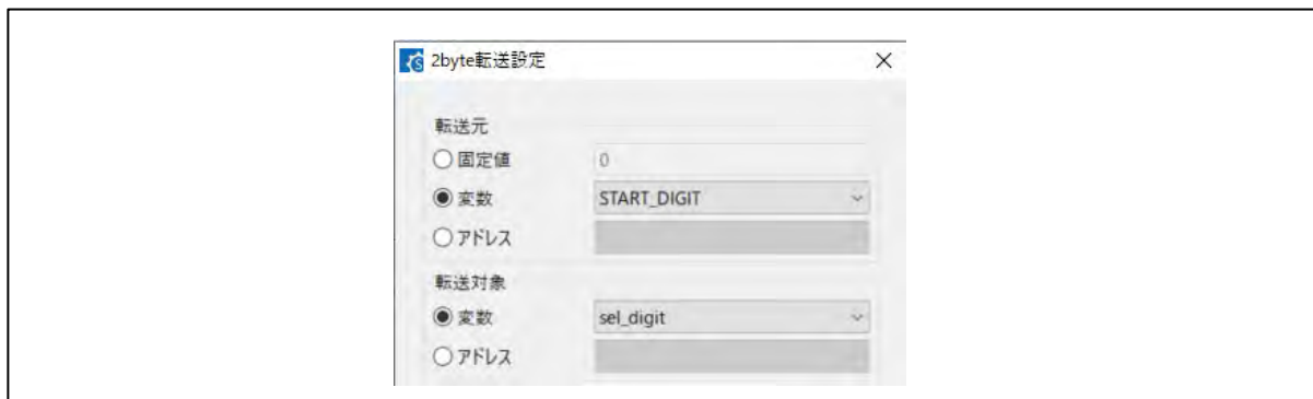
図 6-12 桁選択信号の初期化用 2byte 転送
