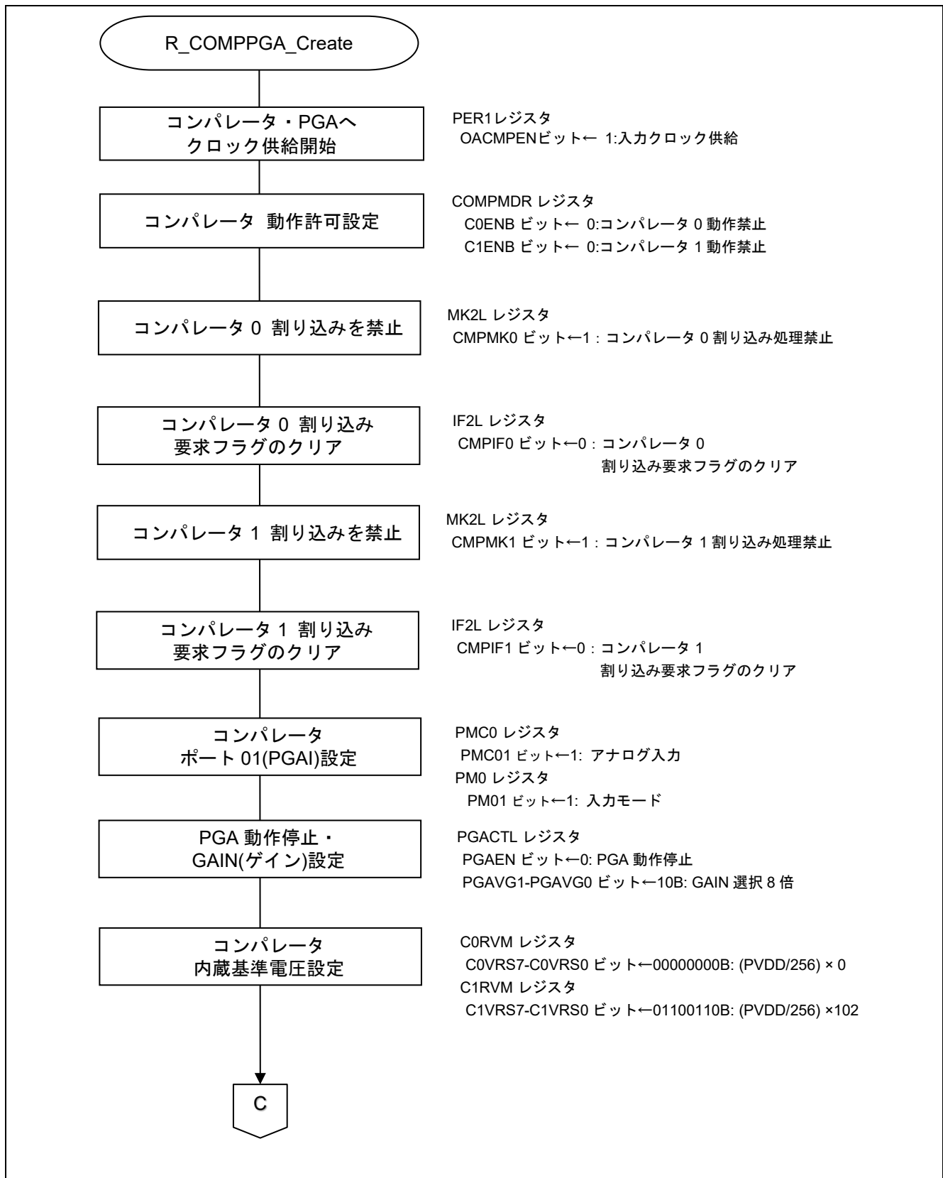
図 4.20 コンパレータ・PGA 初期設定(1/2)
