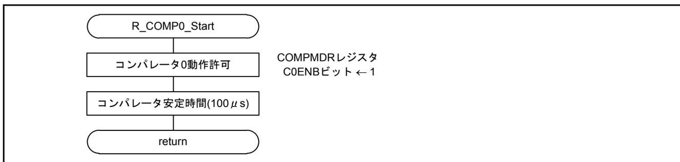
図4.7 コンパレータ 0 動作開始設定
