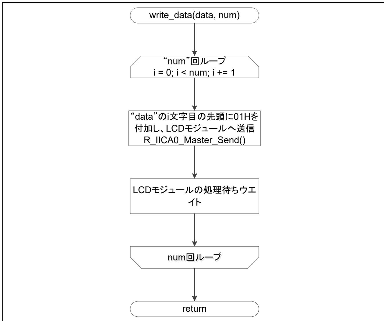
図 5.15 LCD キャラクタディスプレイ表示データ送信関数
