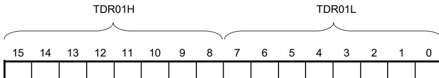
$$\begin{aligned} \text{デューティ} &= (\text{TDR01 の設定値}) / (\text{TDR00 の設定値} + 1) \times 100 \\ 10[\%] &= (\text{TDR01 の設定値}) / (39999 + 1) \times 100 \\ &\Rightarrow \text{TDR01 の設定値} = 4000 \end{aligned}$$
