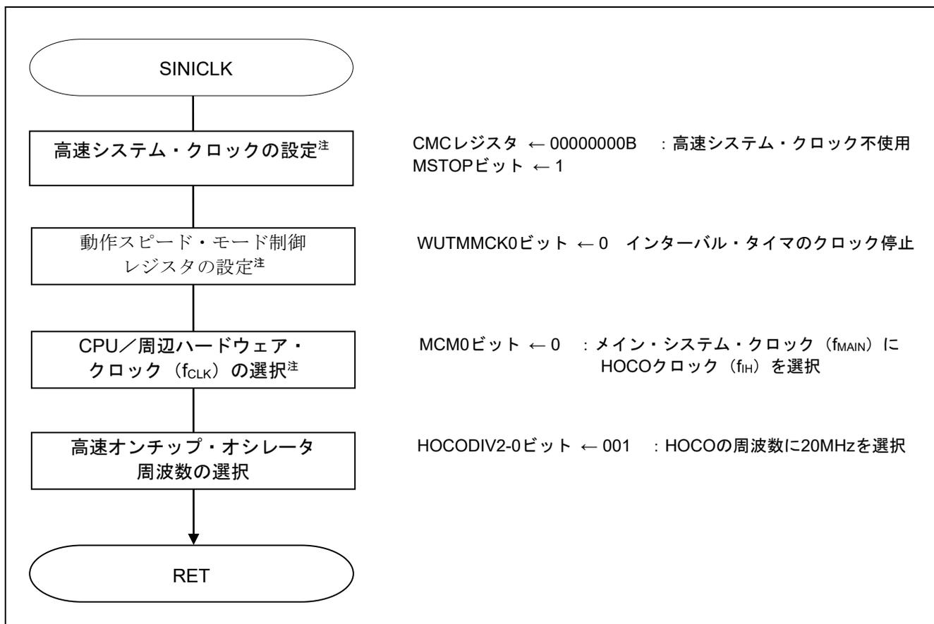
図 5.4 クロック発生回路の設定
