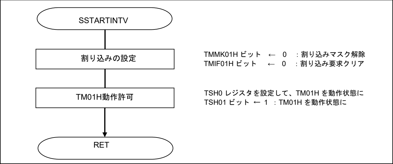
図 5.10 1ms インターバル・タイマの起動処理関数
