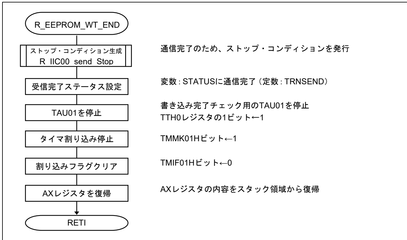
図 5.25 データ書き込み完了処理
