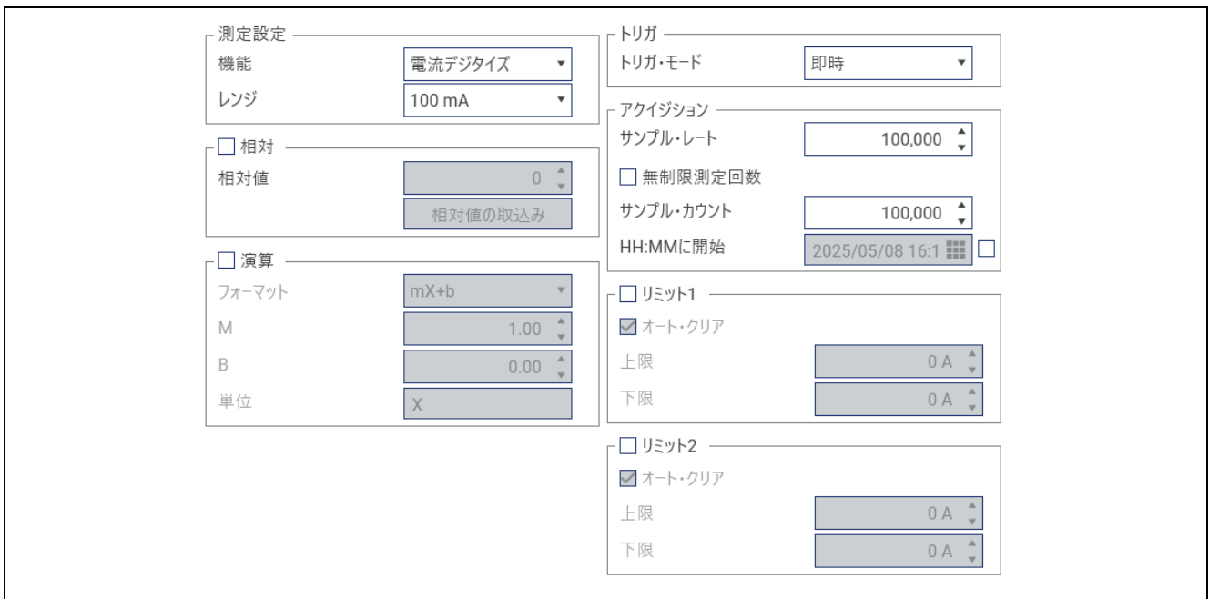
図 7.4 KEITHLEY/KickStart ・ 消費電流計測設定
