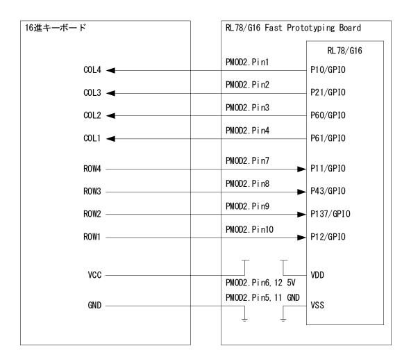
図 2-5 RL78/G16 FPB と 16 進キーボードの端子結線概略図
