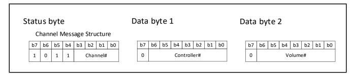
図 1-7 コントロールチェンジメッセージ (チャンネルボリューム)
