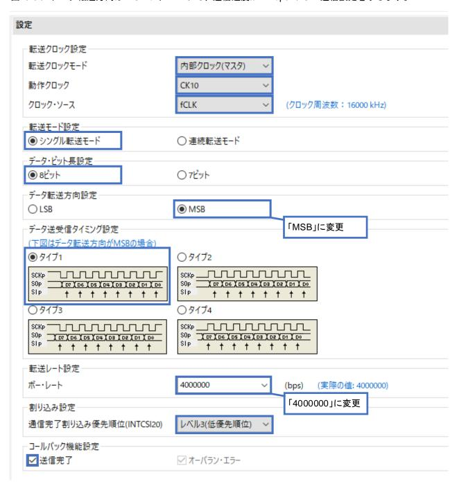
図 3-3 SPI の通信設定
