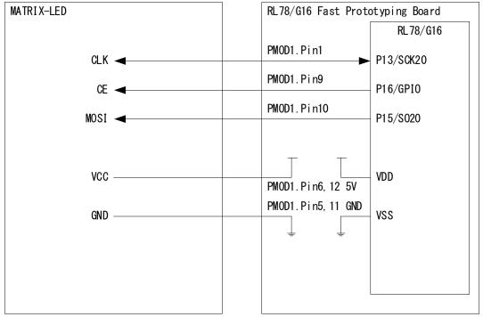
図 2-4 RL78/G16 FPB と MATRIX-LED の端子結線概略図
