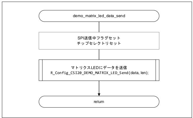
図 3-14 マトリクス LED データ送信処理
