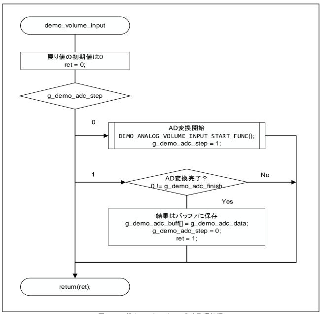
図 3-10 ボリュームスイッチ入力取得処理
