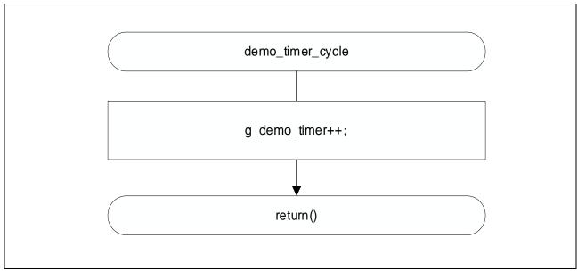
図 3-13 システムタイマカウント処理
