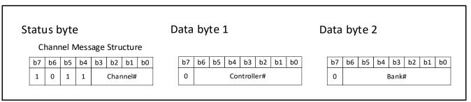
図 1-6 コントロールチェンジメッセージ (バンクセレクト)
