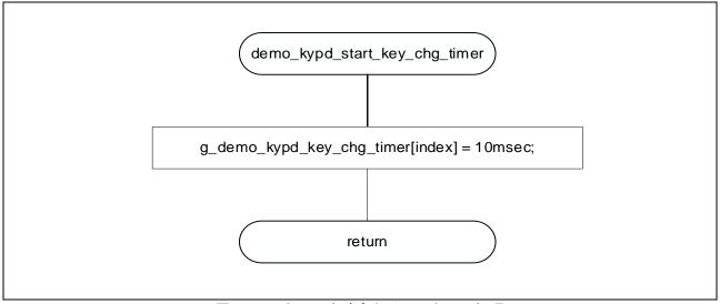
図 3-25 キー入力確定タイマスタート処理
