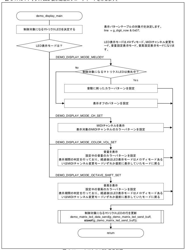
図 3-11 マトリクス LED 表示処理
