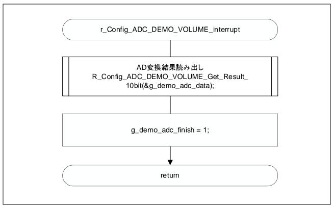
図 3-17 AD 変換完了割り込み処理
