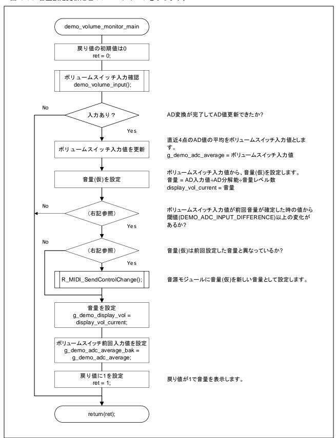
図 3-9 音量設定更新処理
