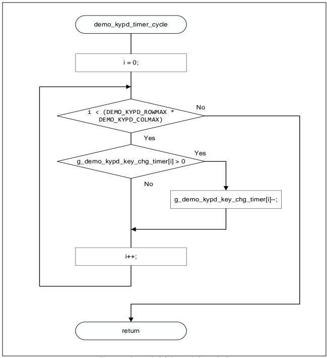
図 3-24 キー入力確定タイマカウント処理
