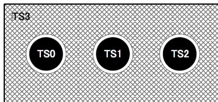
図 8 MEC+シールド電極構成例
