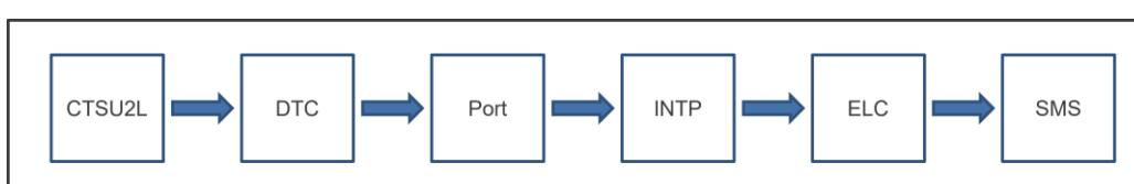
図 6 RL78/G22 で SMS 計測時に使用するモジュールのフロー
