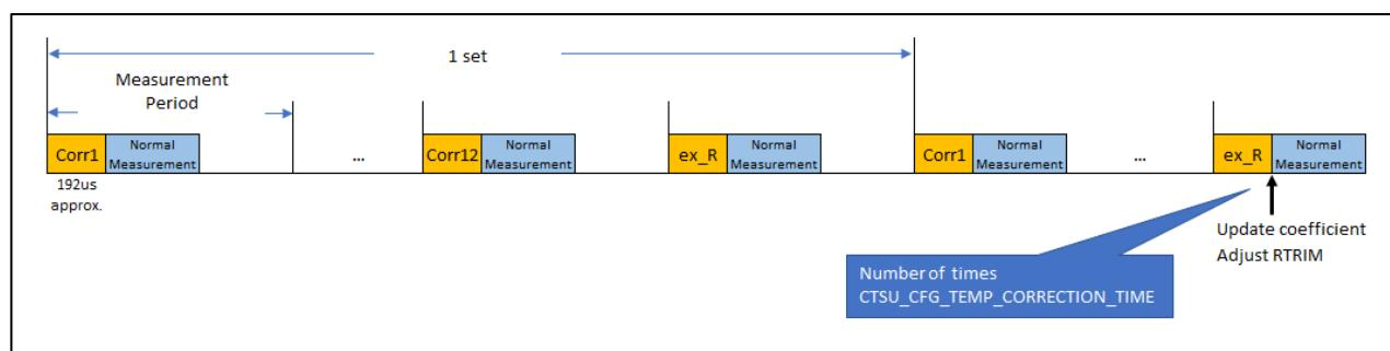
図 16 温度補正計測タイミングチャート
