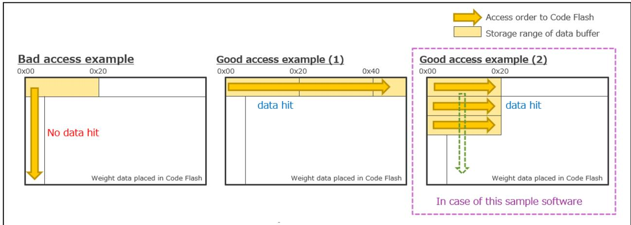
図 3-3 Code Flash へのアクセス順序最適化
