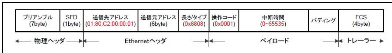
図1.4 PAUSE フレームのフレーム形式
