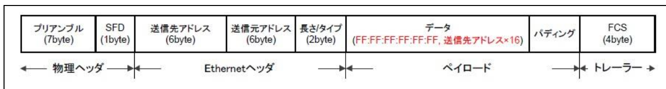
図1.5マジックパケットのフレーム形式
