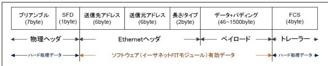
図1.3 Ethernet II /IEEE802.3 のフレーム形式
