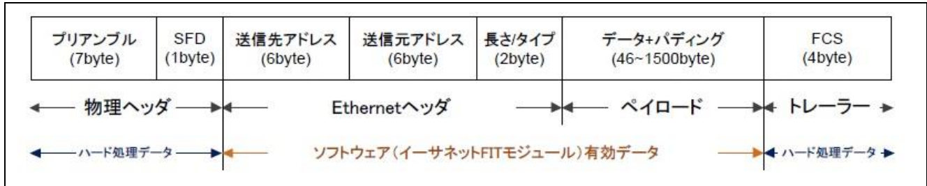
図1.3 Ethernet II/IEEE802.3 のフレーム形式
