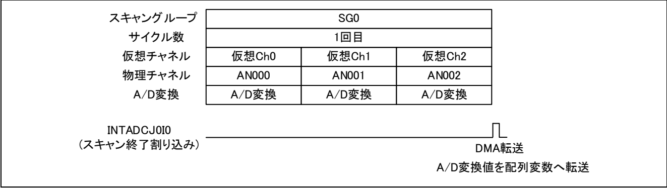
図 3.8.1 DMA 転送を使用した動作例
