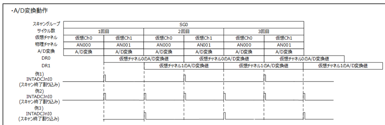
図 2.1.2 スキャン終了割り込み発生タイミング
