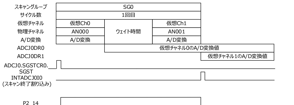
図 3.9.3 通常 A/D 変換 (仮想チャンネル間ウェイト挿入) 動作例
