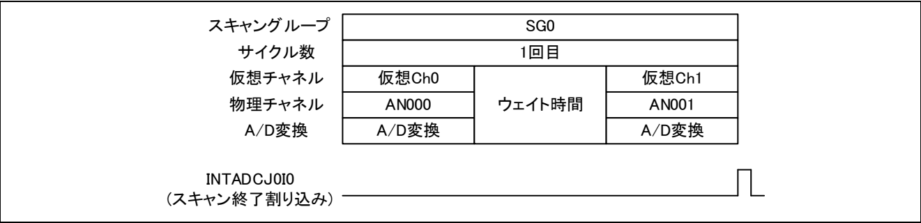
図 3.9.1 通常 A/D 変換 (マルチスキャン) 動作
