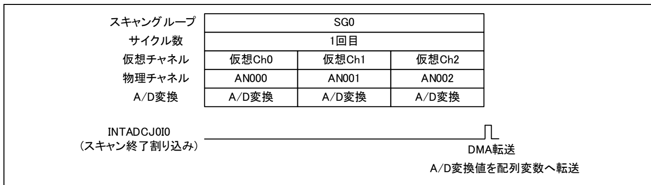
図 3.7.1 DMA 転送を使用した動作例
