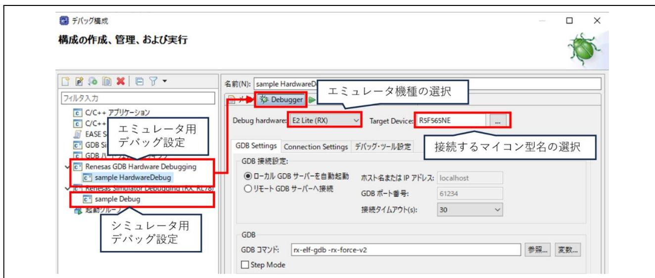
図 4-1 エミュレータ接続の設定箇所
