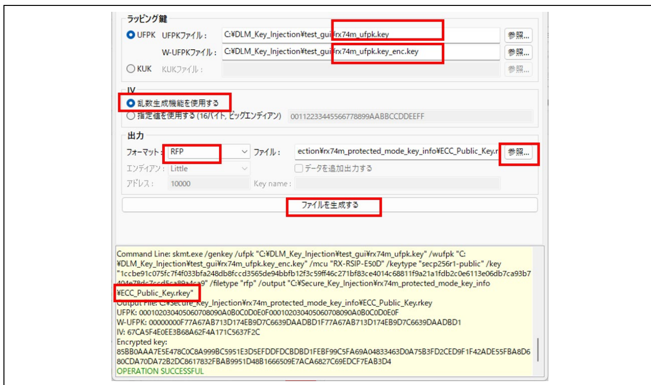
図5-3 GUI を使用した ECC 公開鍵の RFP 鍵注入ファイルの生成
