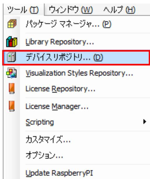
デバイスリポジトリダイアログにて、「インストール」をクリック、ファイルダイアログが表示されますので、スタック同梱の ESI ファイル「Renasas-EtherCAT-Slave.xml」を指定してください。インストール結果については下図の通り青枠内に表示されますのでご確認ください。正常に処理が行われた場合は結果の横に
