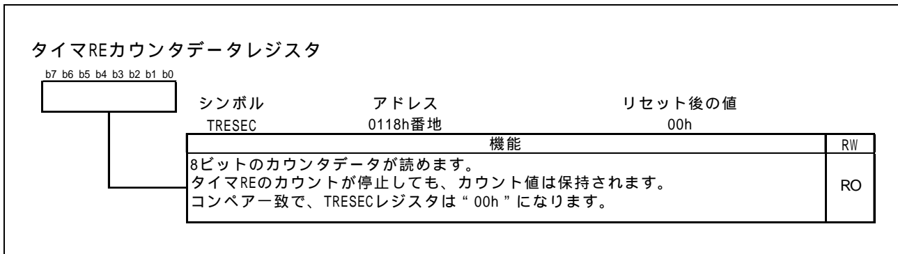
図 3.2 アウトプットコンペアモード時のTRESECレジスタ
