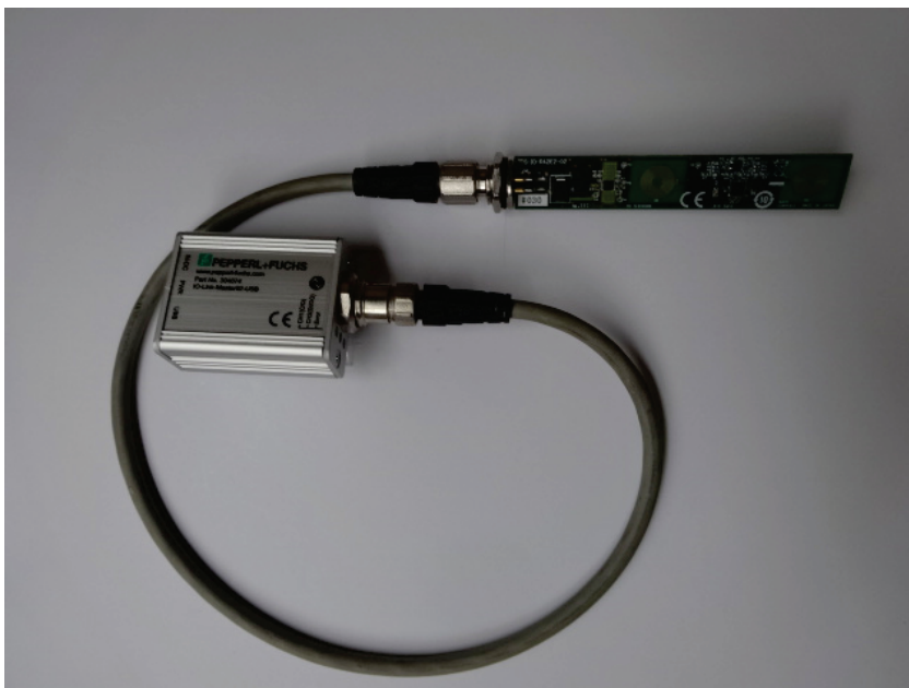
図 6-8 USB マスターと Inductive Sensor Board 接続
