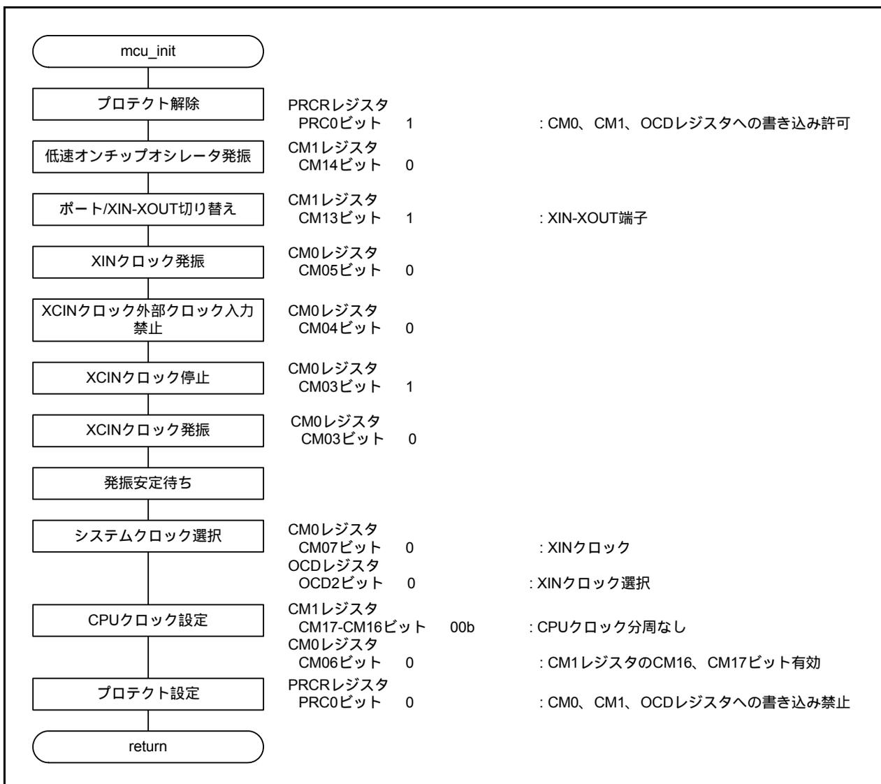
図 3.4 システムクロック設定処理
