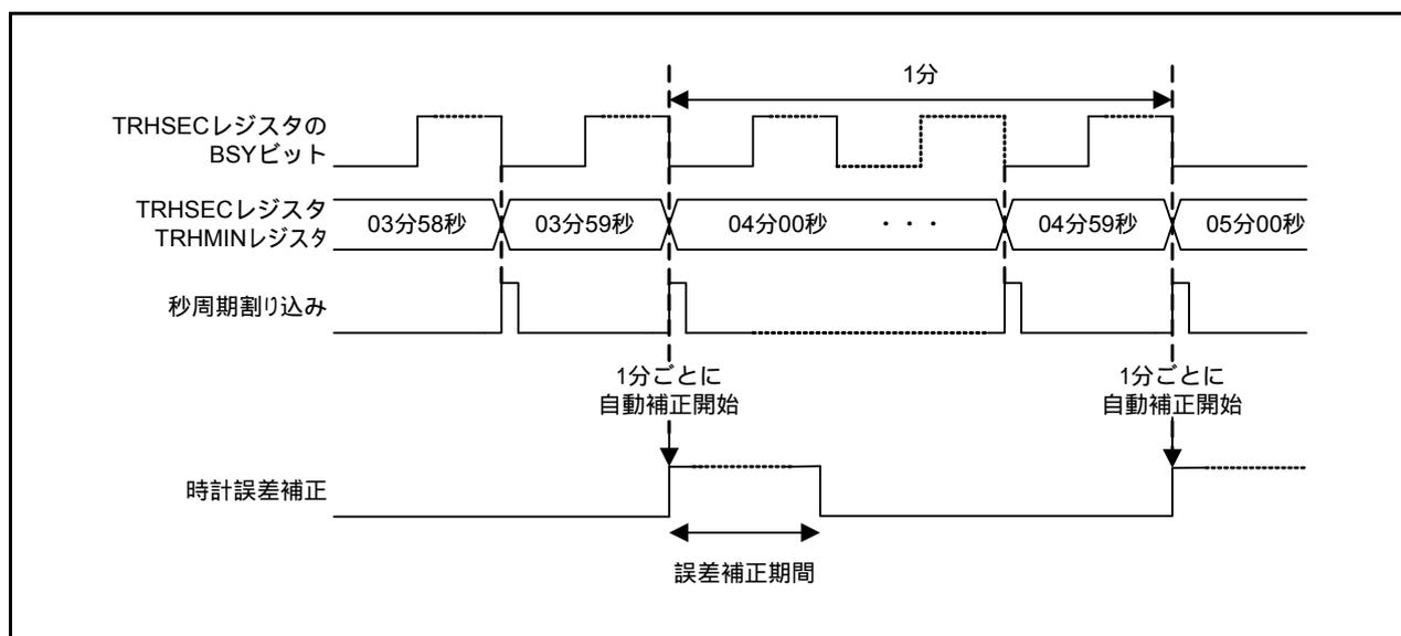
図 1.2 自動補正機能、マイナス側補正の動作例
