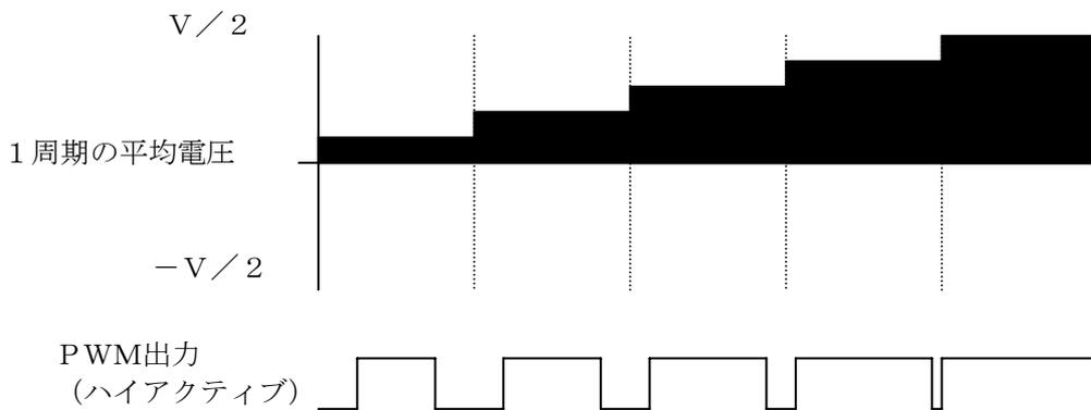
図 3.4.5 交流の正弦波形を時分割して方形波に置き換える
