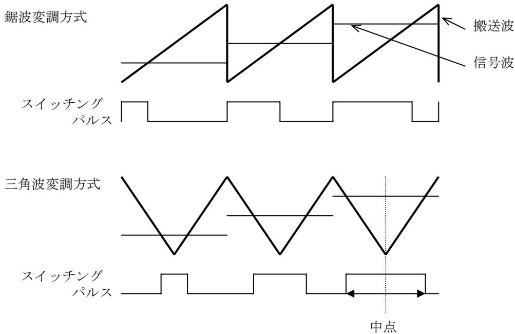
図 3.2.3 キャリアの変調方式
