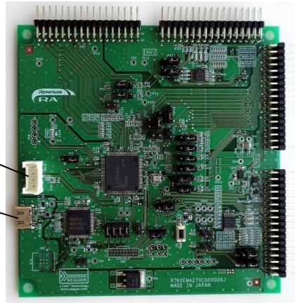
図 4-2 RA6T2 CPU ボードとインタフェース
