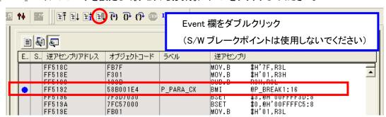
(5) 正しい設定値であれば、ブレークを設定した箇所でプログラムが停止します。この場合は、(6)の内容は読み飛ばしてください。
