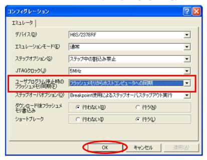
なお、フラッシュメモリの内容がホストコンピュータ側へ読み込まれるタイミングはプログラムを停止させたときで、 読み込まれている最中はアウトプットウィンドウの[Debug]タブ上に"Flash memory reading ・・・"と表示されま す。
