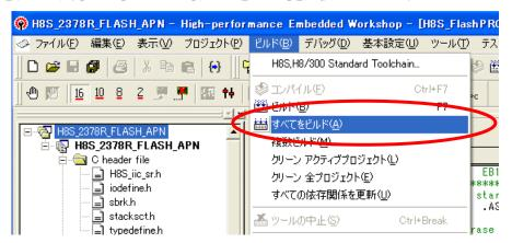
ビルド作業終了後、アウトプットウィンドウの[Build]タブ上の表示が"0 Errors, 0 Warnings"になることを確認してください。
