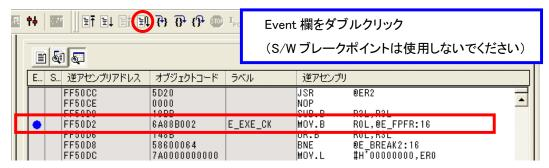
(12) ブレークを設定した箇所でプログラムが停止します。HEW のレジスタウィンドウを表示させて FPFR の値(汎用レジスタ ROL の値)を確認してください。
