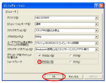
これでE10A-USBエミュレータがエミュレーション実行中にメモリアクセス(ショートブレーク)を行わなくなります。
