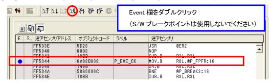
上記箇所にブレーク設定してプログラムを実行すると、IIC バスインタフェース 2 のチャネル 0(IIC2\_0)によるスレーブ受信モードに入り、IIC\_マスタ送信側からデータが送信されるまで待機状態となります。プログラム実行後にフラッシュメモリに書き込むデータを送信してください。
