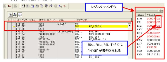
(7) 次に消去プログラムのダウンロード処理エラーチェック方法について説明します。以下の箇所(ラベル "E\_DL\_CK")にブレークを設定して[リセット後実行]アイコンをクリックしてください。
