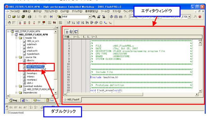
(2) 各処理のエラーチェックを行う前にフラッシュメモリに格納されているサンプルプログラムを内蔵 RAM に転送します。"flash\_erpr\_128"関数の先頭(行番号 128)にブレークを設定して[リセット後実行]アイコンをクリックしてプログラムを実行してください。
