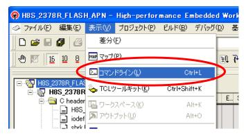
コマンドラインウィンドウで以下のように"mf 0x001000 0x07FFFF 11"と入力してコマンド実行してください。 "0x001000~0x07FFFF"は今回の消去対象ブロックのアドレスで、"11"は任意の値です。
