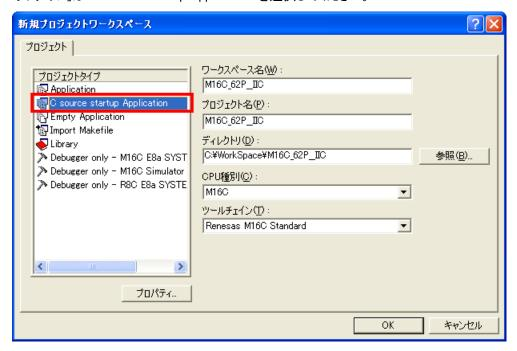
[ROM size]は"512k"を選択し、[Use OnChip Debugging Emulator]は"E8"を選択してください。この設定でエミュ レータのファームウェア領域が"H'FF600~H'FFDFF"、ワーク RAM 領域が"H'00400~H'0047F"に確保(セク ション設定)されます。
