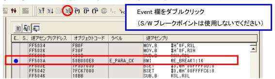
(5) 正しい設定値であれば、ブレークを設定した箇所でプログラムが停止します。この場合は、(6)の内容は読み飛ばしてください。
