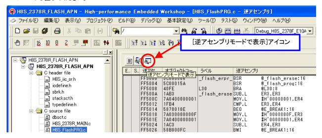
(4) 最初にシンボル(PR\_FL\_TOP、PROG\_N)の設定値エラーチェック方法について説明します。以下の箇所(ラベル "P\_PARA\_CK")にブレークを設定して[リセット後実行]アイコンをクリックしてください。
