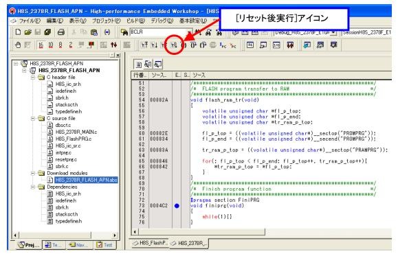
サンプルプログラムの動作として、書き込みプログラムのダウンロード、フラッシュメモリの初期化処理が終わると IIC バスインタフェース 2 のチャネル 0(IIC2\_0)によるスレーブ受信モードに入り、フラッシュメモリに書き込むデータが IIC\_マスタ送信側から送信されるまで待機状態になります。フラッシュメモリに書き込むデータ(今回は4k バイト)を送信してください。
