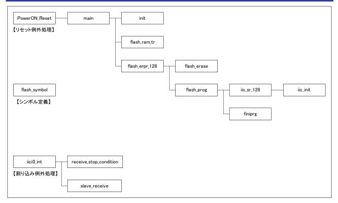
図 5.1 サンプルプログラム階層構造図
