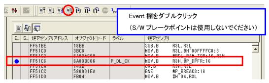
(8) ブレークを設定した箇所でプログラムが停止します。
