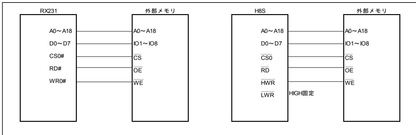
図1.3 バス幅が 8 ビット時のバス接続例
