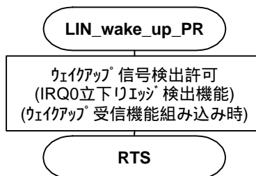
図 19 ウェイクアップ信号受信準備用関数フローチャート
