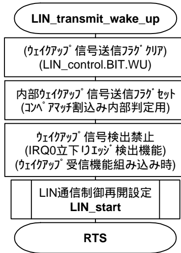
図 18 ウェイクアップ信号送信用関数フローチャート
