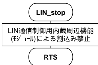
図 16 LIN 通信制御停止用関数フローチャート
