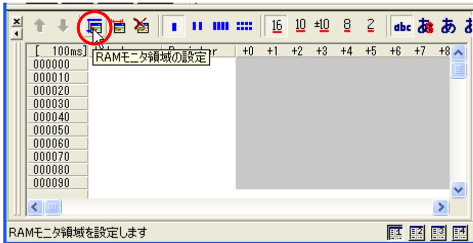
(31) [RAM モニタ領域設定]ダイアログボックスが表示されます。[追加]ボタンを押してください。
