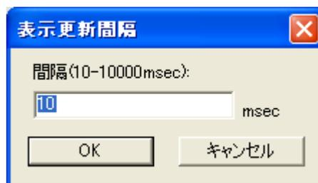
GUI 入出力機能のアイテムで指定したアドレスの値をユーザプログラムが更新する場合、GUI 入出力ウィンドウのアイテムへの状態反映は、ここで指定した表示更新間隔毎に行われます。
