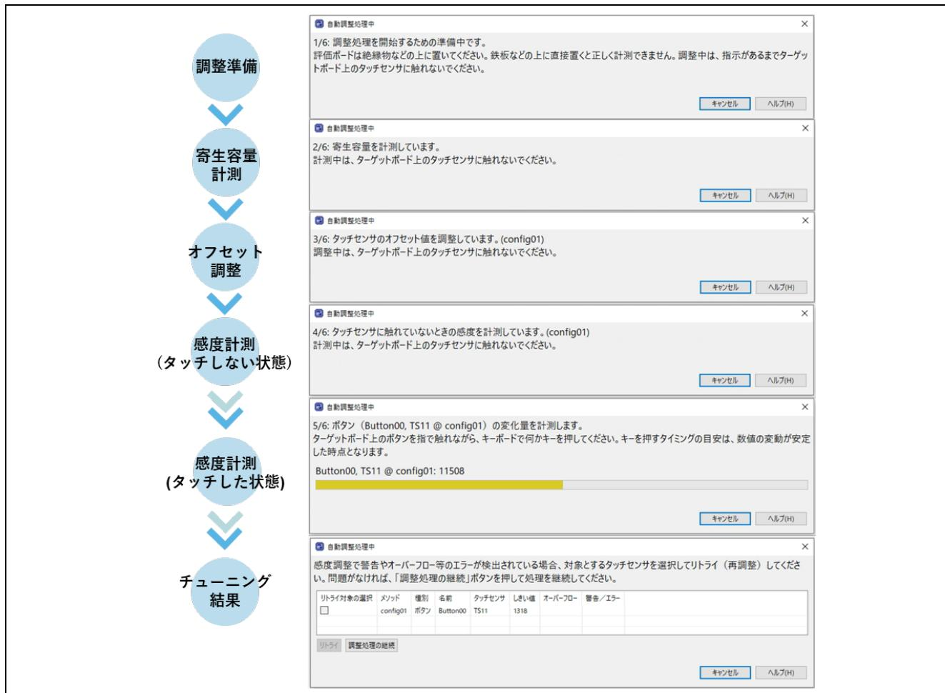
図 7-2 QE for Capacitive Touch を使用した自動チューニング
