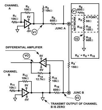
FIGURE 2. CHANNEL TO CHANNEL TRANSHYBRID BALANCE
