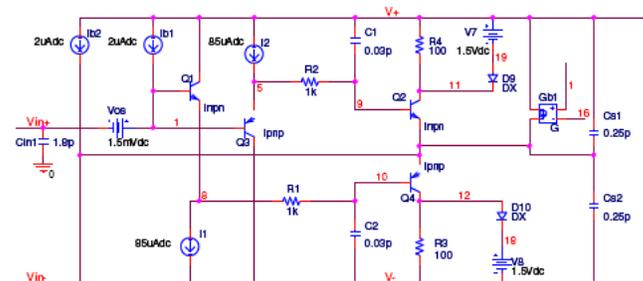
FIGURE 3. INPUT STAGE OF A CFA (EL5165)
