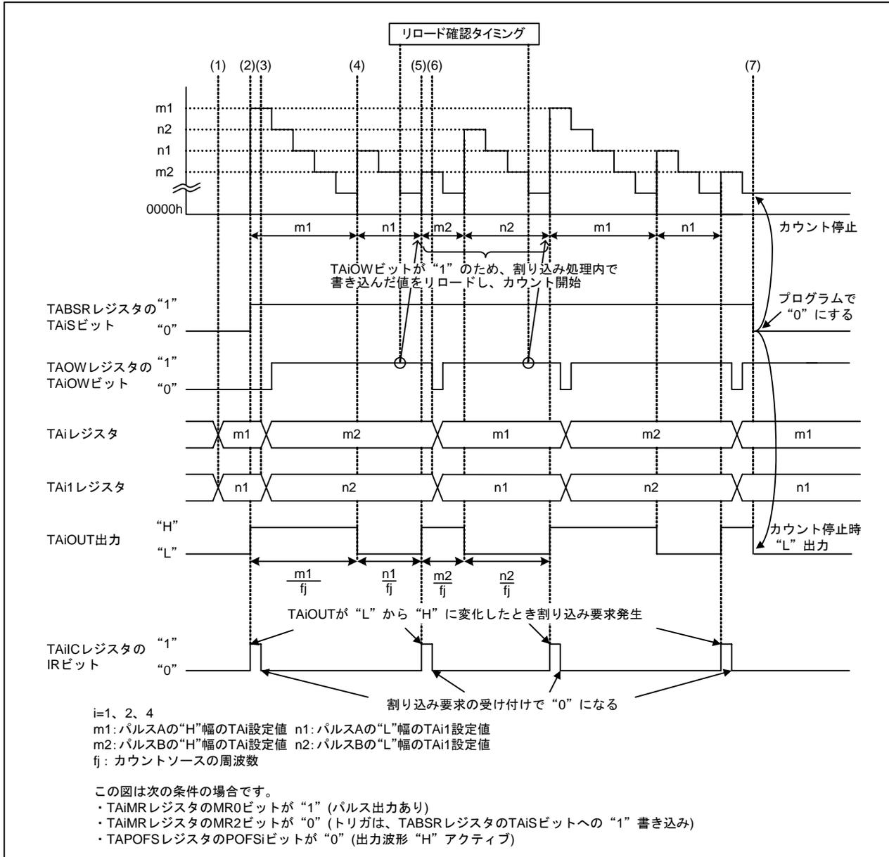
図 4.2 プログラマブル出力モード時の動作例
