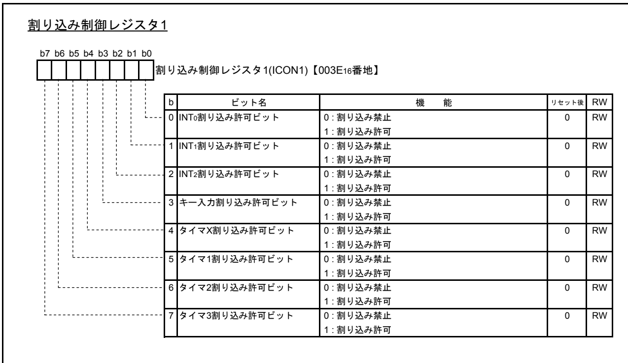
図4.42 割り込み制御レジスタ1の構成
