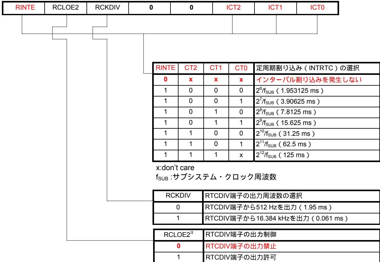
図4 - 2 - 3 リアルタイム・カウンタ・コントロール・レジスタ2 (RTCC2) のフォーマット
