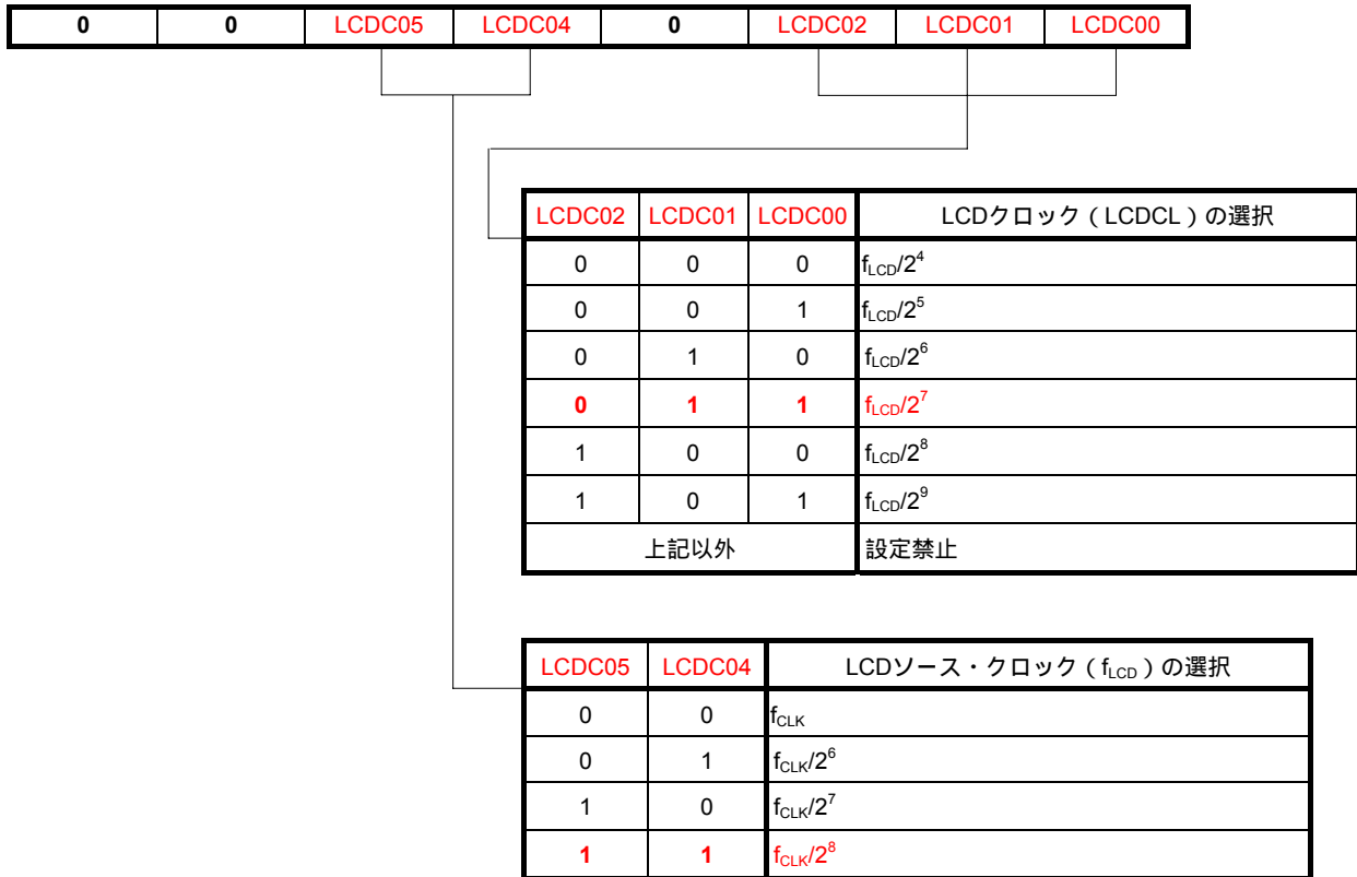
図4 - 3 - 3 LCDクロック制御レジスタ0 (LCDC0) のフォーマット
