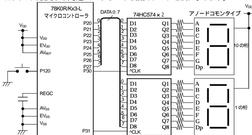
注意：この回路イメージは接続の概要を示す為に簡略化しています。実際に回路を作成される場合は、端子処理などを適切に行い、電流など電気的特性を満たすように設計してください。（P121～P124は入力専用ポートになりますから個別に抵抗を介して $V_{DD}$ 又は $V_{SS}$ に接続して下さい）
