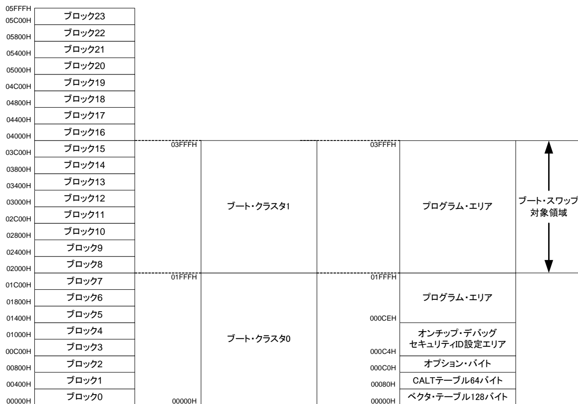
図 1 - 2 ブロック番号とブート・クラスタ (フラッシュ・メモリ・サイズが 24 K バイトの場合)
