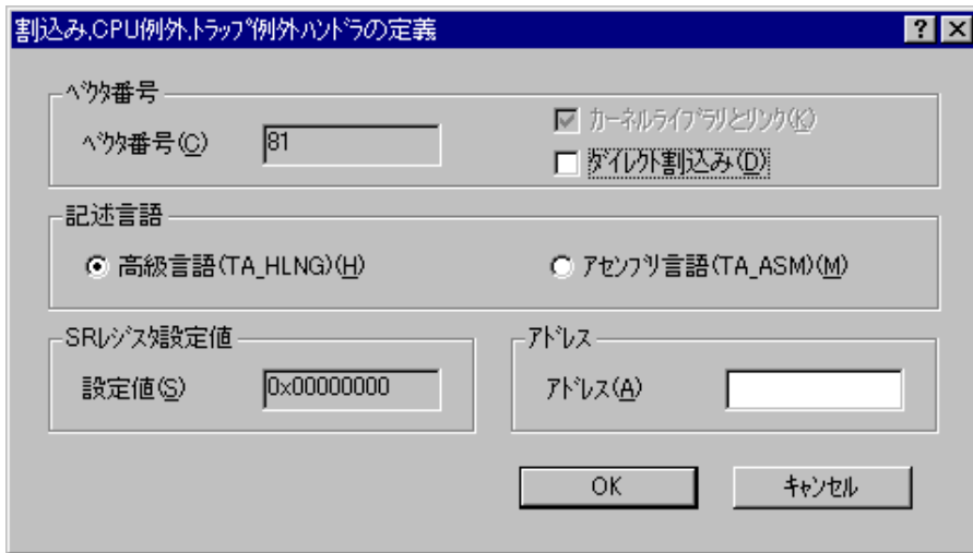
図3-7 割り込み,CPU 例外ハンドラの定義画面
