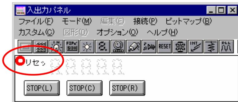
リセット・ボタンの位置は、[ モード(M) ] [ 配置(E) ] を選択後、リセット・ボタンをドラッグ&ドロップすることにより、自由に変更できます。
