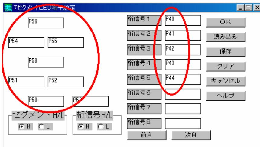
78K0 と 78K4 は入出力ポート P5, P4, 78K0S は P1, P4 の各ビットを、7セグメント LED 端子に接続しています。
