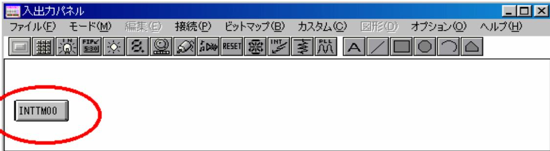
入出力パネル上に内部割り込みボタンが表示されます。
