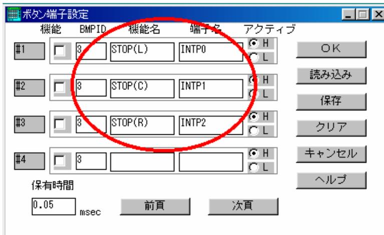
ボタン端子設定ダイアログでは、入出力パネル・ウインドウに表示するボタンの接続情報を設定します。
