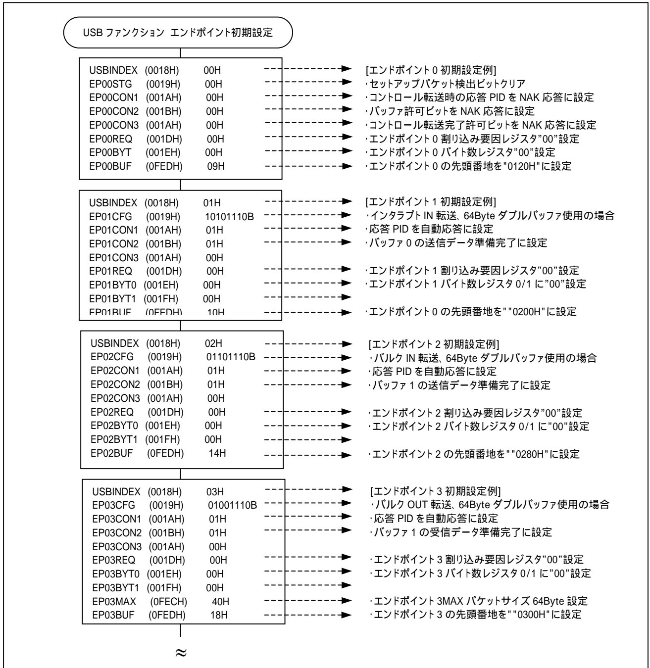
図 5.4 USBファンクション エンドポイント初期設定例
