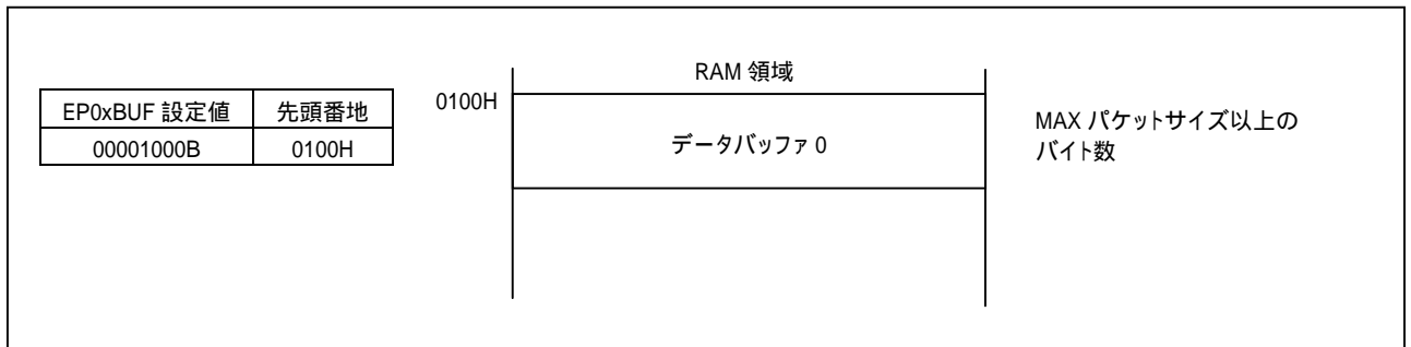
図 5.7 エンドポイント x データバッファ 0 設定例
