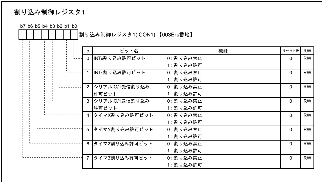
図4.44 割り込み制御レジスタ1の構成
