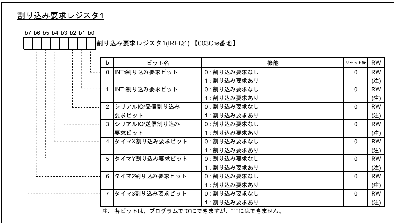
図4.42 割り込み要求レジスタ1の構成
