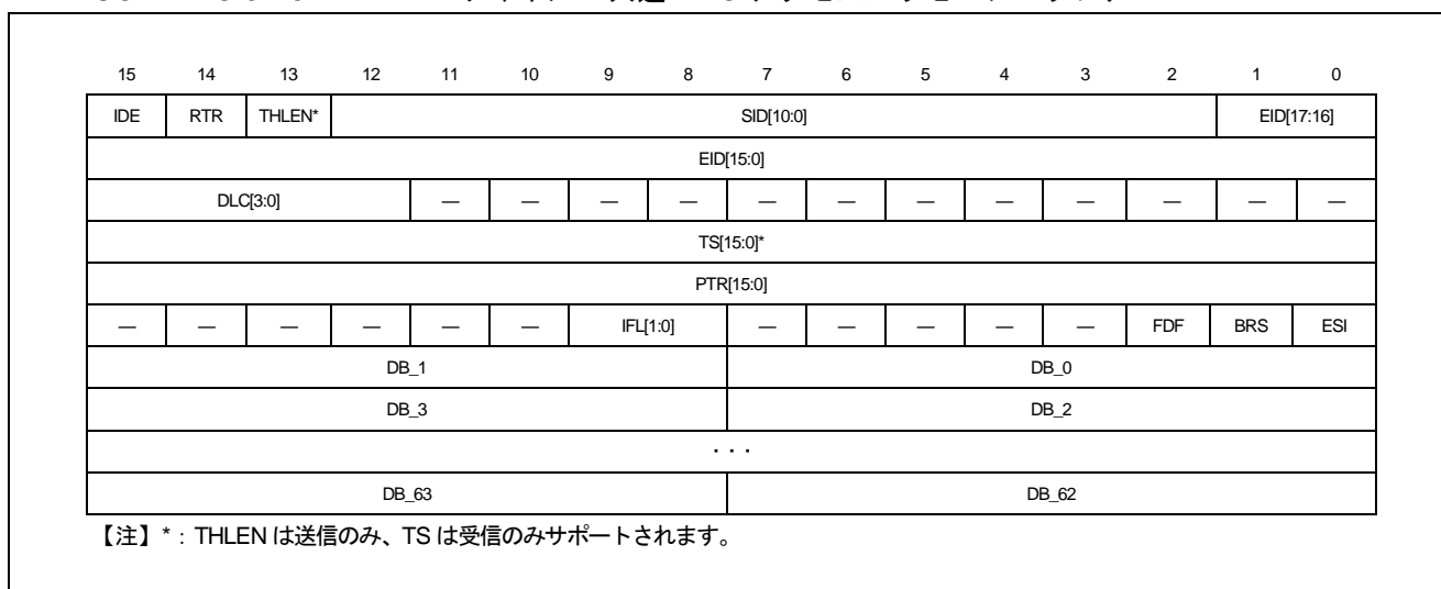
図 3-7 RA6M5 グループのメッセージバッファ構成
