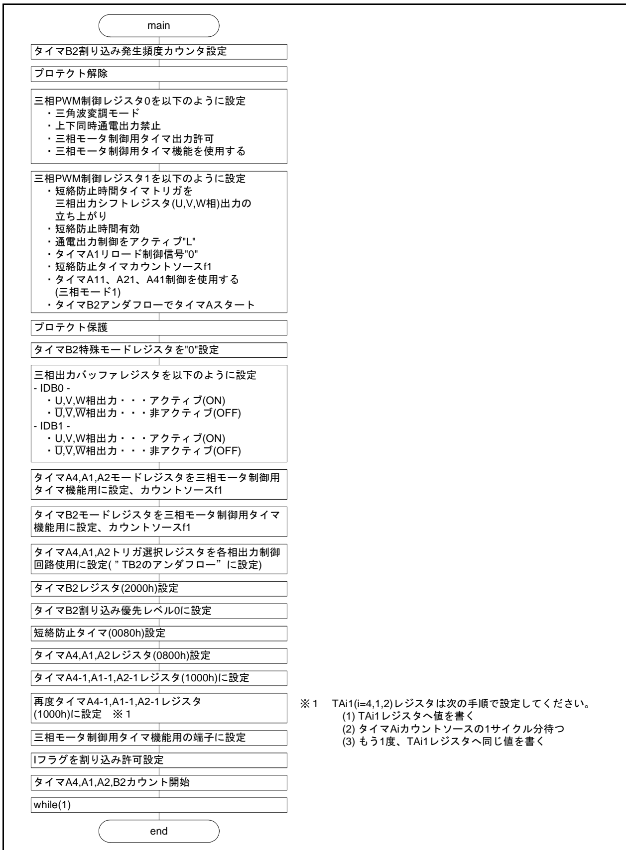
図 4.1 三角波変調(三相モード1)のフローチャート
