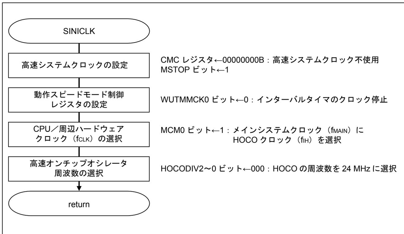
図 5.5 クロック発生回路の設定
