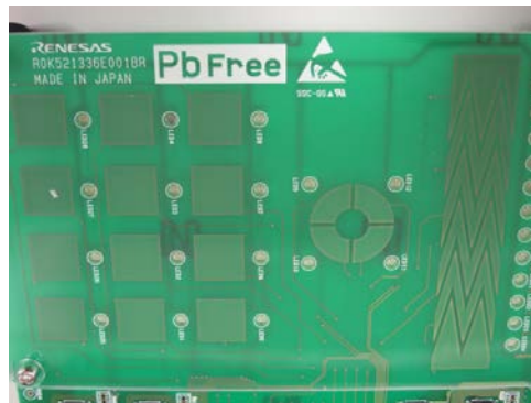
図1-3 プリント基板に形成されたタッチ電極 左からキー、ホイール、スライダ
