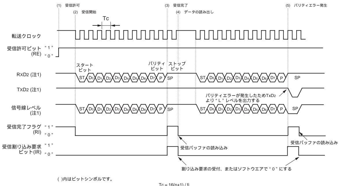
図1 クロック非同期形シリアル I/O モードの受信動作タイミング
