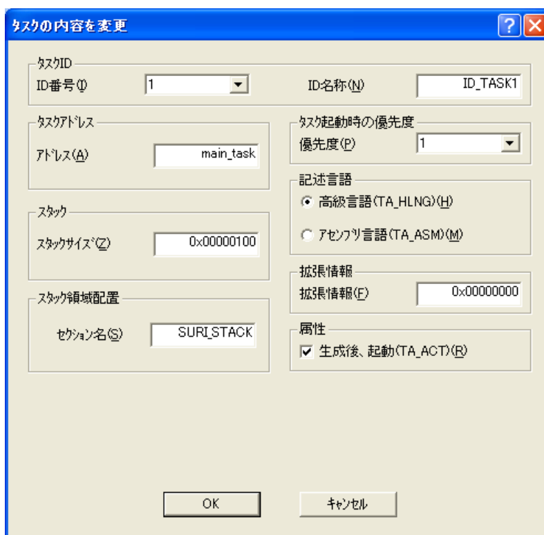
図3-61 GUIコンフィギュレータ タスクの定義 [ダイアログ] (SAMPLE7)
