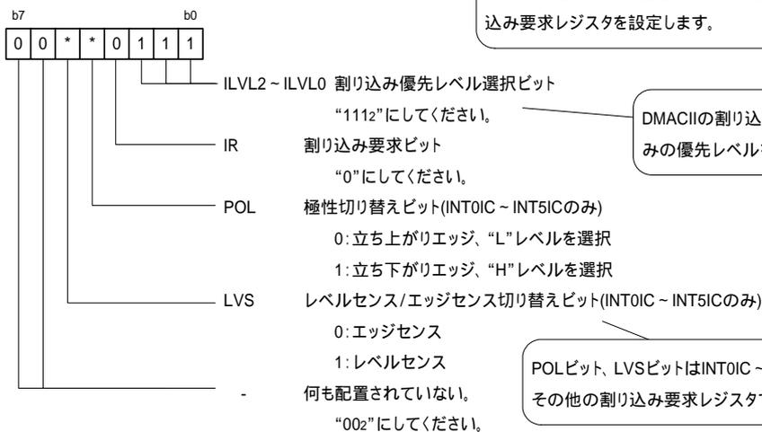
DMACIIの割り込み要因として使用する全ての割り込み要求レジスタを設定します。
