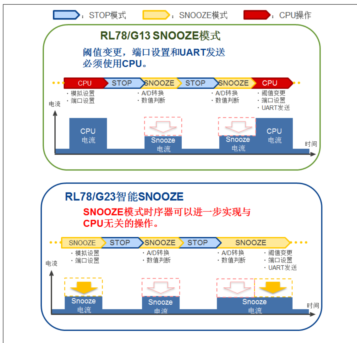
图 6: SNOOZE 模式时序器, 无需 CPU, 功耗低
