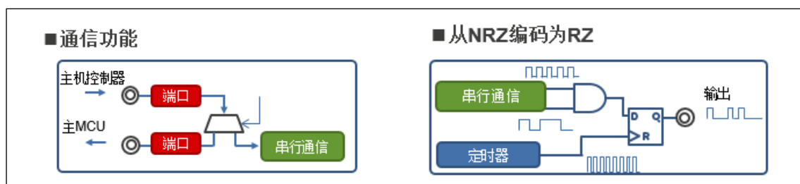
图 8：逻辑与事件链接控制器使用案例
