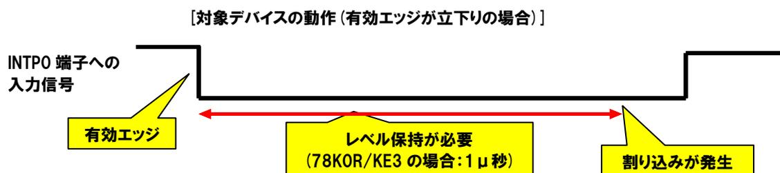
しかし、シミュレータの場合はこのノイズ除去回路をシミュレーションしていないため、有効エッジが発生すれば、割り込みが発生します。(信号のレベル保持が不要です。)
